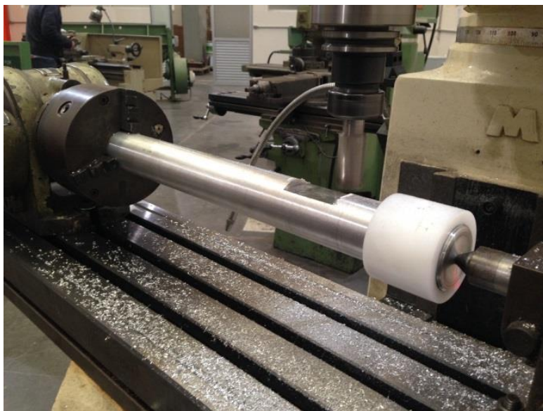
Figura 20 - Célula de carga durante o fresamento da estricção que receberá os extensômetros, a peça em nylon serve para proteger a rosca de fixação de cavacos gerados no processo.
